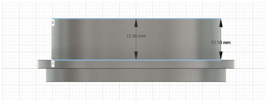
Il faudrait raccourcir la partie diamètre 2" de longueur 12.50 mm à 4 mm 0/-0.1 en conservant une planéité parfaite de la portée usinée ainsi que le parallélisme de cette portée par rapport à la collerette côté filetage M54x0.75 (ce sont les faces d'appui d'un objectif côté usinage sur une caméra côté collerette)
