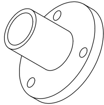
Diamètre 18.90mm important : Passage dans un alésage de de 19 mm doit passer mais ne doit pas avoir de jeu lors du montage
