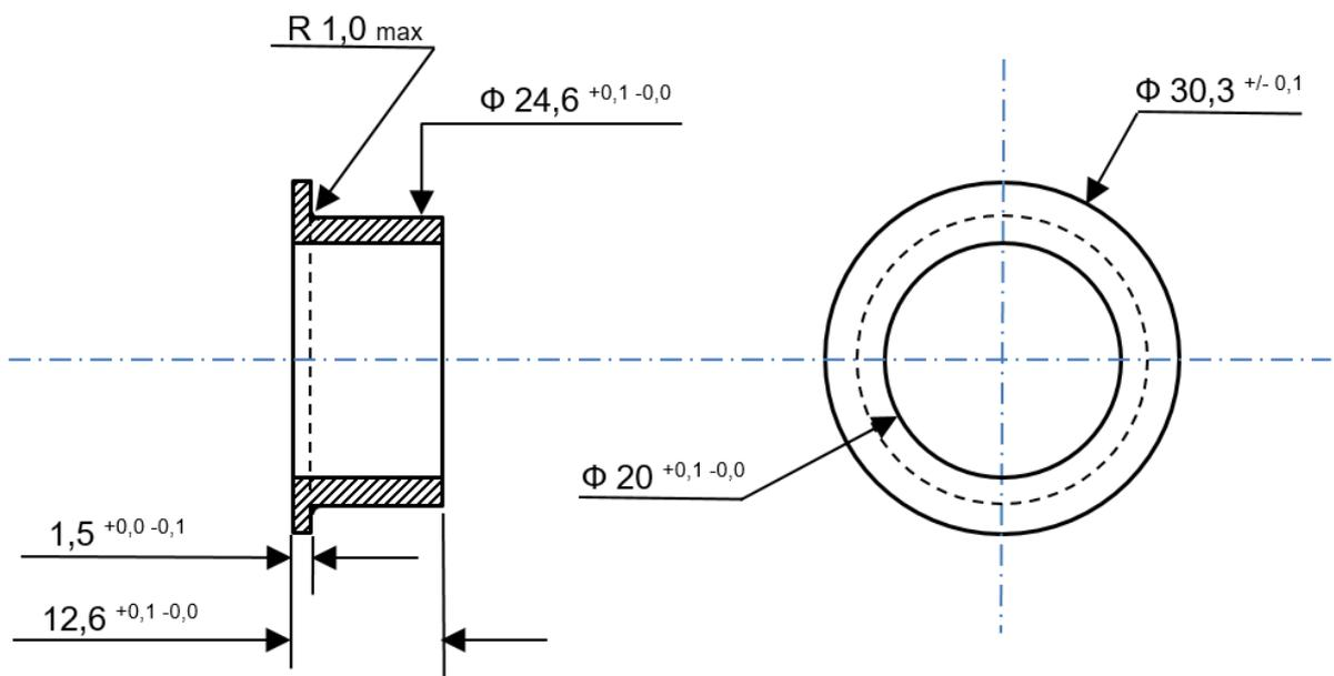
Adaptateur SRAM XX (interface UDH) pour cadre YETI SB150
