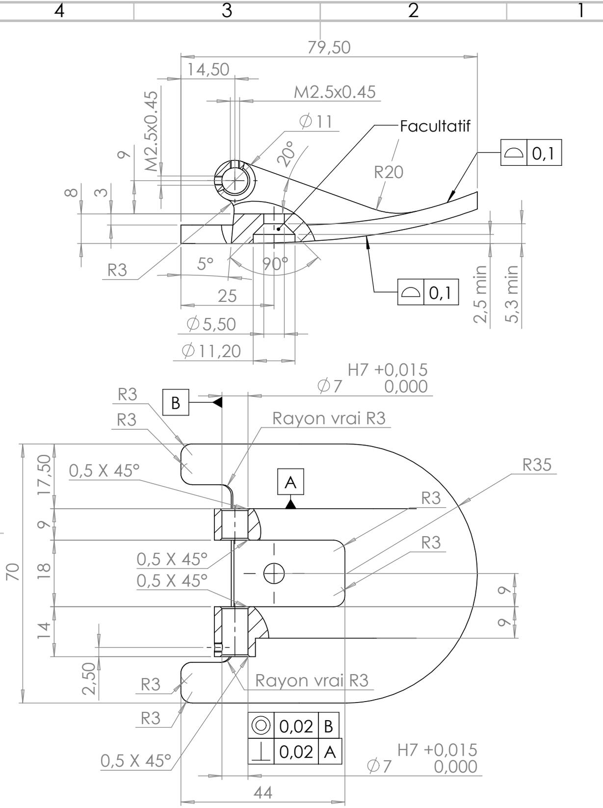
Nota : le trou de passage de vis à tête fraisée en E3 est facultatif, il est présent pour faciliter l'usage
