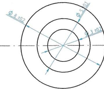
Fabrication de 2 arrêts de gaine pour une serrure de véhicule Renault
