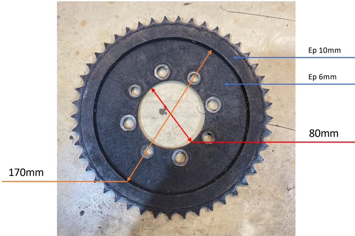
Une face avec une réduction de 10mm à 6mm
