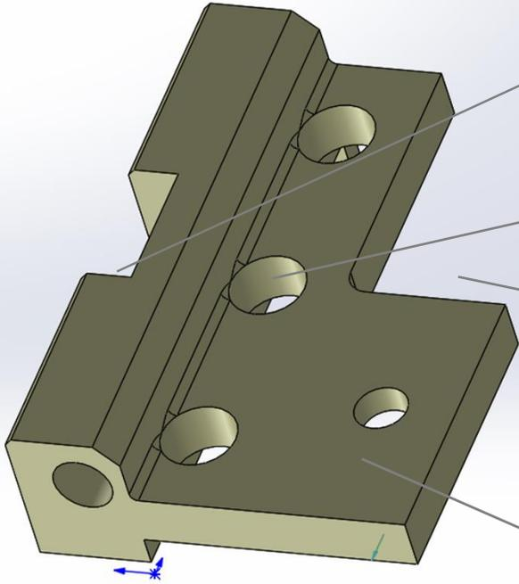
Surface d'appui pour le caoutchouc de la butée
