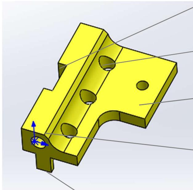
3 trous pour accéder aux vis M8 de fixation de la chape sur le profilé alu et pouvoir le serrer après positionnement
