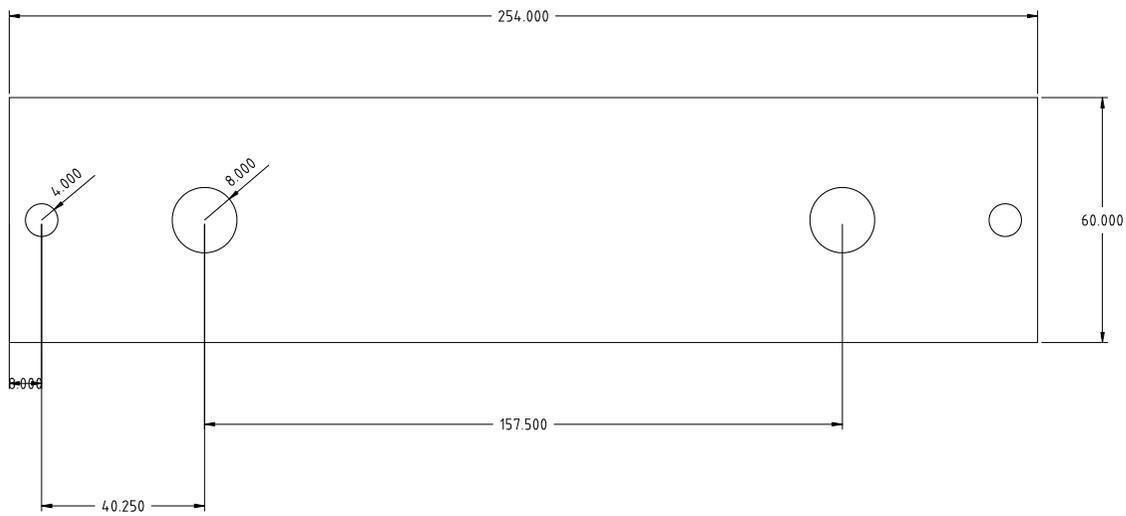
Platine pour fixation de paliers à roulement sur profilé alu
