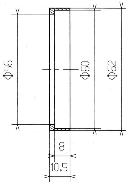
Bague pour joint spi  $\Phi$  60 ext.
