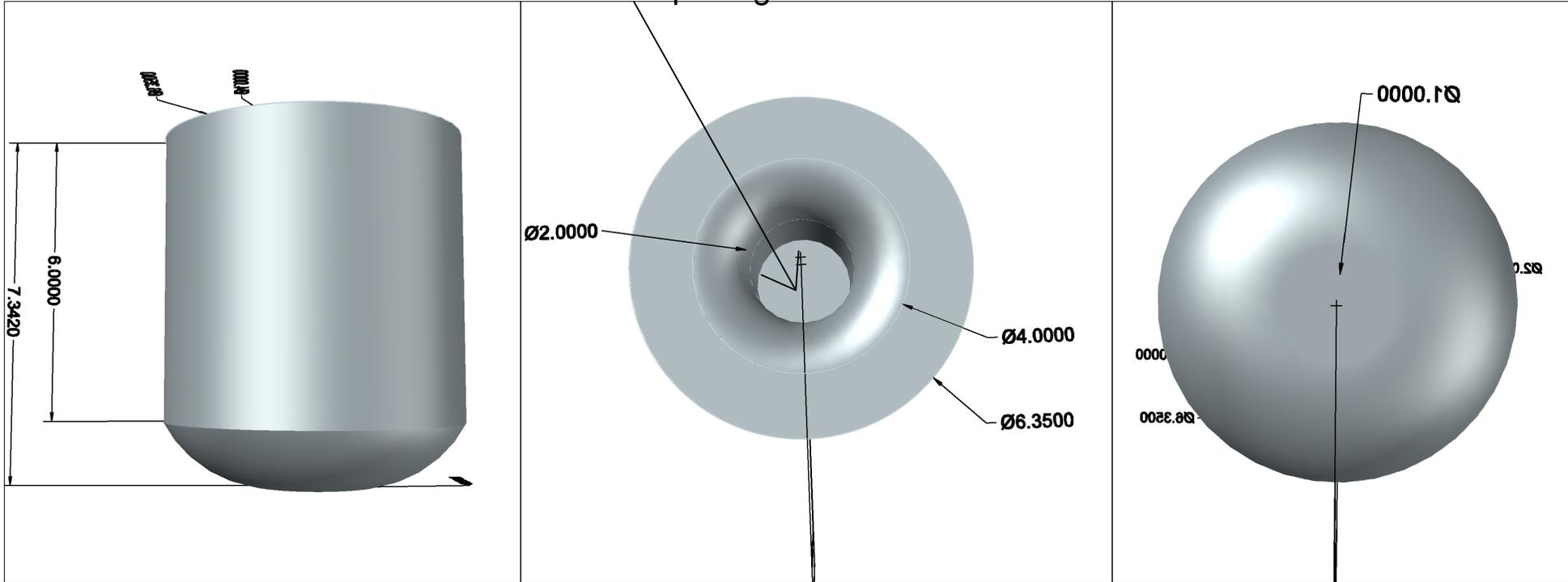
Hauteur totale 7.342mm Diamètre extérieur 6.35mm
