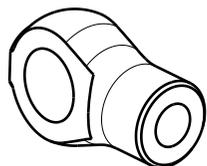
Note: sur les zone d'étanchéité hydraulique A/B/C Rugosite Ra1.6 et stries circulaires et non en spirale.
