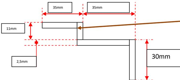
**Cet angle de 90° ne doit pas être formé par pliure mais par soudage si cela est possible**
