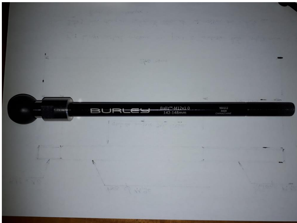
Axe actuel avec un de ses embouts (il est trop court c'est pour cela que j'en fait faire un autre
