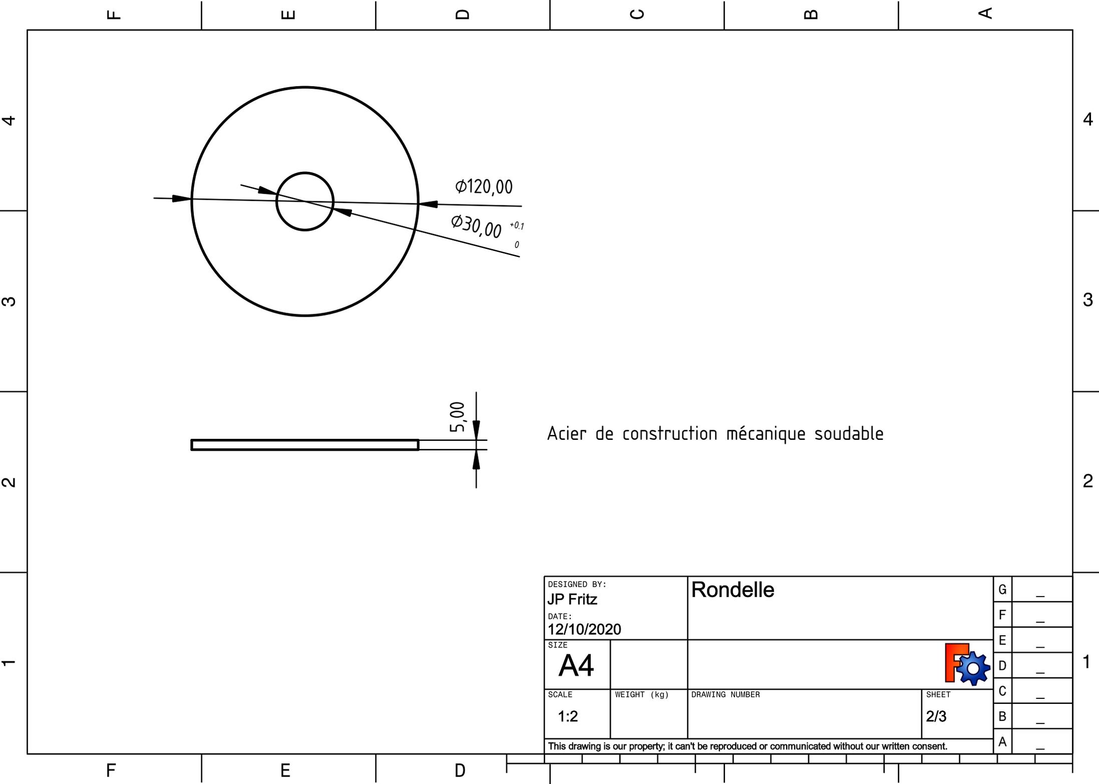
Acier de construction mécanique soudable
