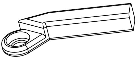
Cavité 3mm (roulement 12x21x7 montage à la main)
