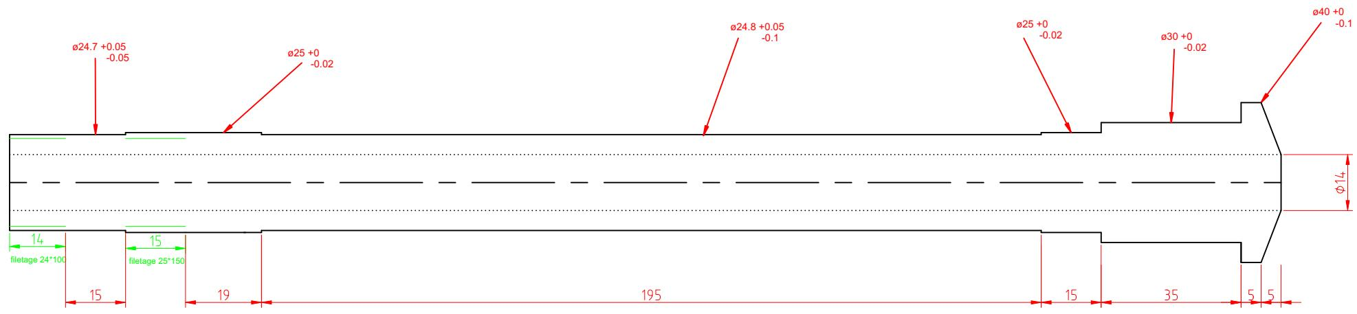
le diamètre 14 sur la longueur n' est pas obligatoire, juste un perçage le plus profond possible suffit
