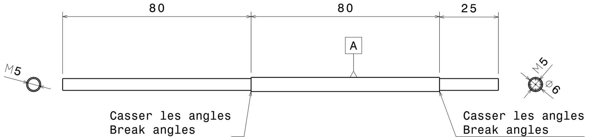
A partir d'un stub de 6mm de diamètre (100Cr6)
