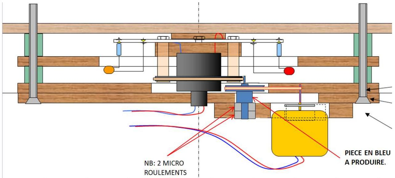
Ci-dessus une vue globale du rôle de transmission de la pièce (en bleu) à fabriquer.
