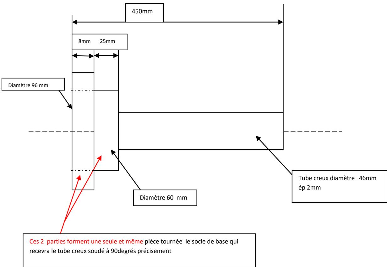
Tube creux encastré et soudée dans l'épaisseur du socle de base
