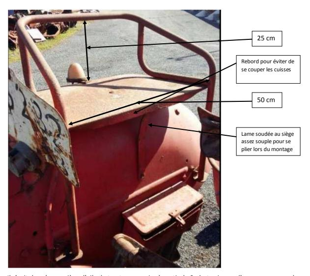
Il s'agit de créer un siège d'aile de tracteur en acier à partir de 3 photos issues d'une annonce sur le bon coin. Les 4 côtes indiquées sont approximatives pour que le siège soit confortable. Le diamètre des tubes est laissé au choix de l'usineur ainsi que les côtes qui ne sont pas indiquées tant qu'elles s'inspirent des photos
