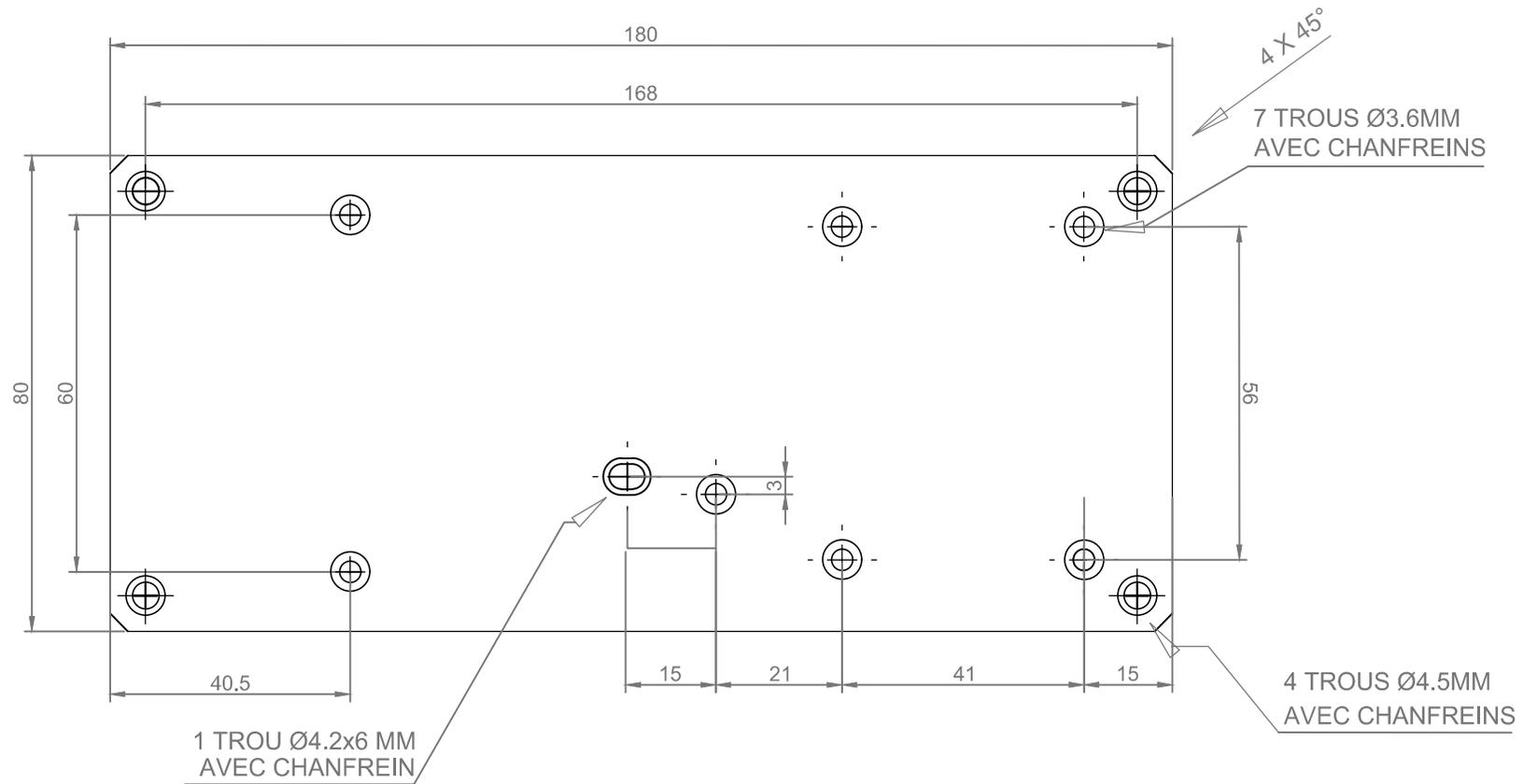
CHANFREINS À RÉALISER SUR LE DESSOUS DE LA PLATINE
