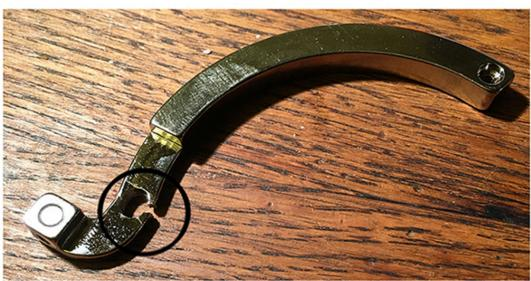
Arceau d'une suspension de microphone «Lauten Audio - Eden LT-386» qui s'est rompu au niveau du trou de 4mm «A». Le trou d'origine présente un jeu important, d'ou la rupture de la pièce à cet endroit-là. (voir Photo jointe)
