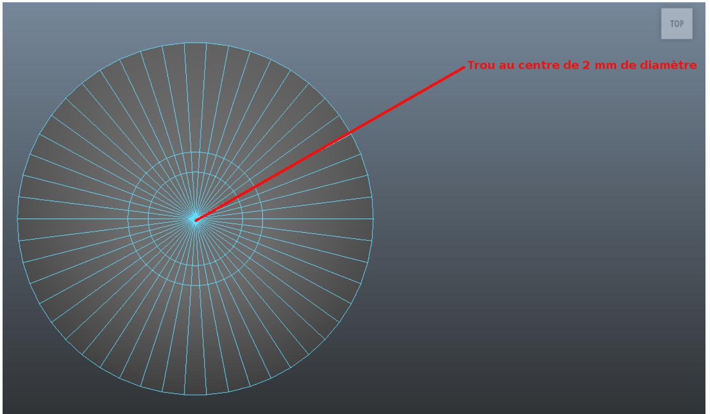
*Le trou central n'apparaît pas sur le schéma mais il devra être présent sur la pièce et permettra de passer une vis pour fixer le hub sur le servo moteur.*
