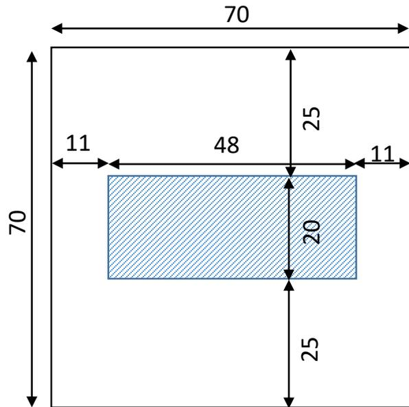
Pour positionner sous carré en Aluminium avec trou
