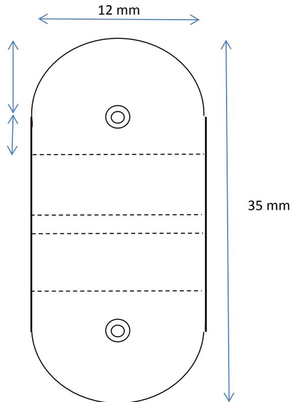
Perçages pour Vis de 4 mm + Fraisage pour la tête de vis
