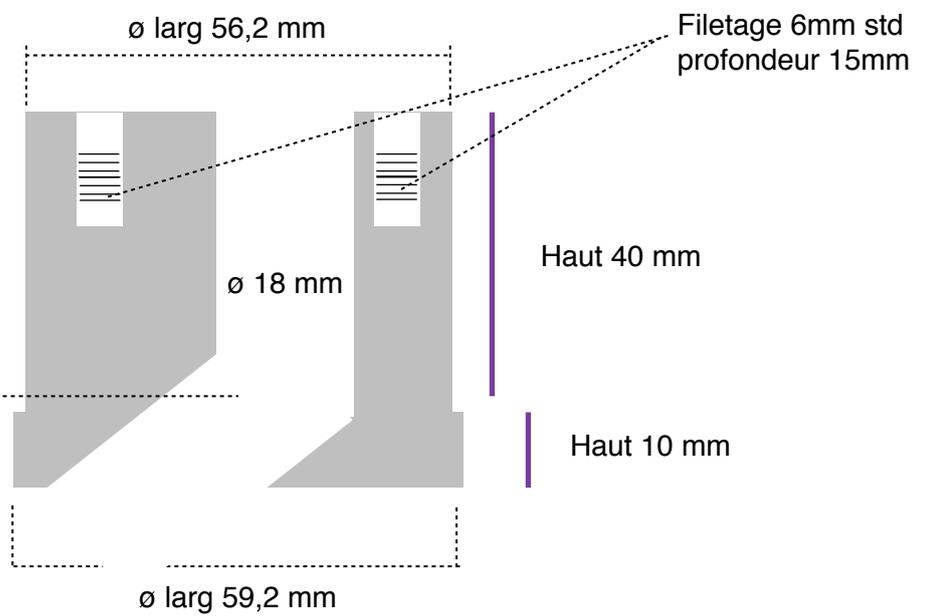
La sortie doit être perpendiculaire à l'axe des emplacements de tiges filetées
