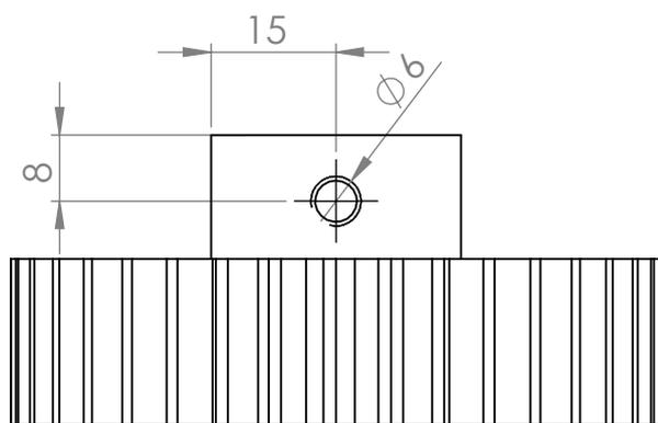
**Percage de diamètre 6 traversant et taraudé de pas gros ISO.
