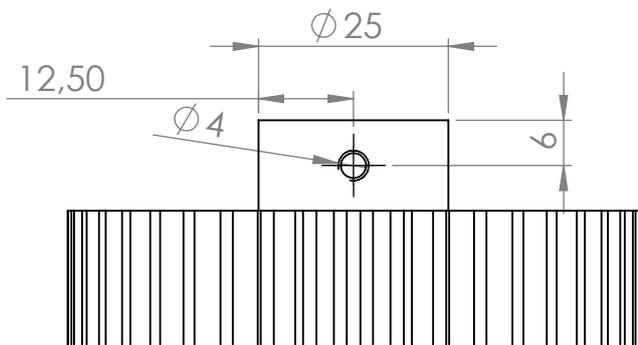
**Le perçage de diamètre 4 est traversant et taraudé de pas gros ISO.
