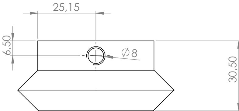
**Percage de diametre 8 traversant et taraudé de pas gros ISO.
